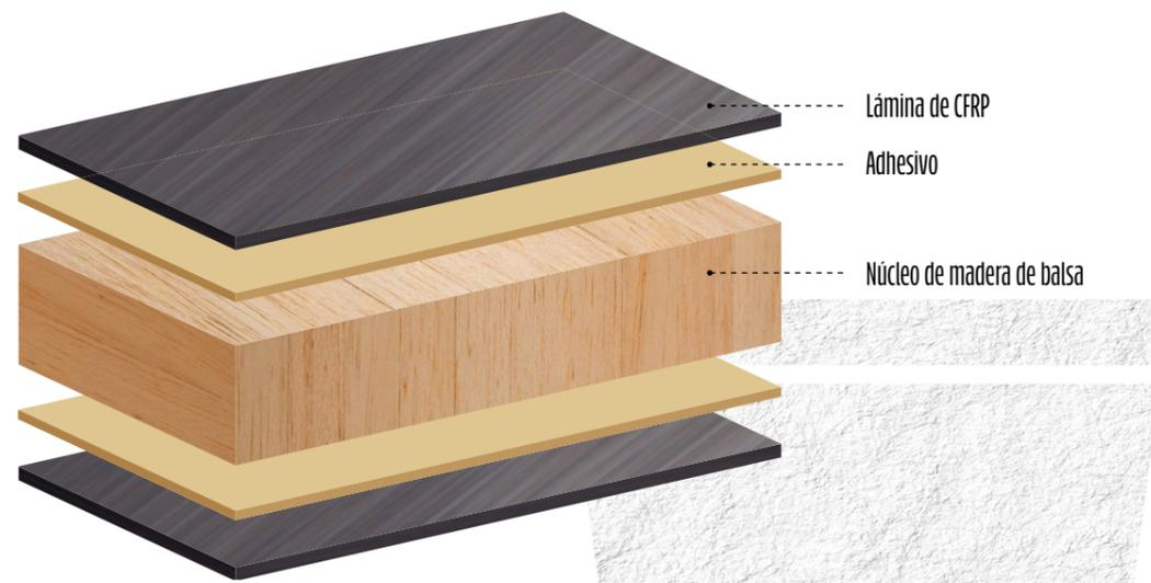
Figura 36. Sección de panel tipo sándwich con núcleo de madera y capas externas de Polímero Reforzado con Fibra de Carbono (CFRP).
