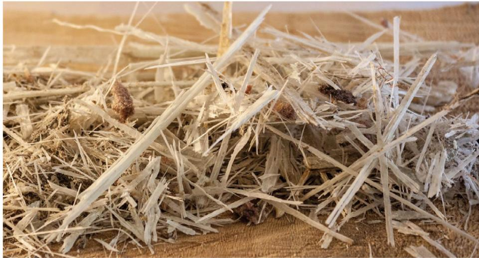
Figura 23. Material compuesto con GFRP tras trituración.
