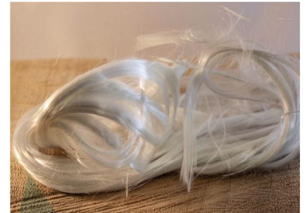
Figura 33. Fibra de vidrio reciclada con (izq.) y sin (der.) trituración mecánica previa tras el tratamiento térmico de Reciclalia.
