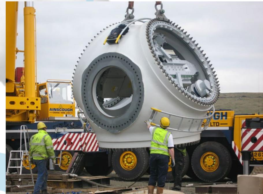
Figura 5. Bujes desarmados de un aerogenerador.
