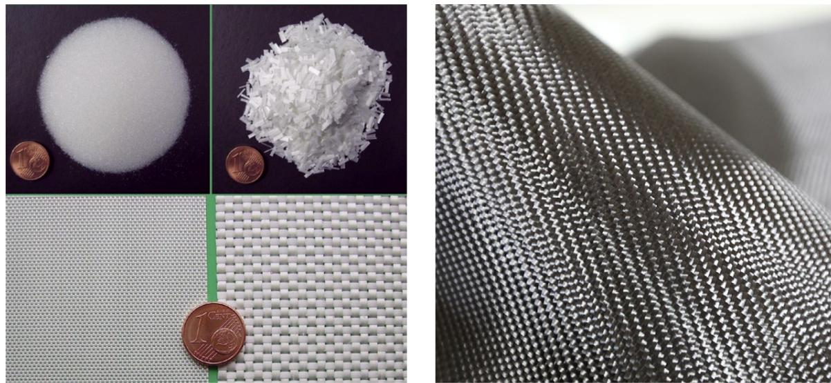
Figura 17. Microesferas y tejidos de fibra de vidrio (izq.) y fibra de carbono laminada (der.).
