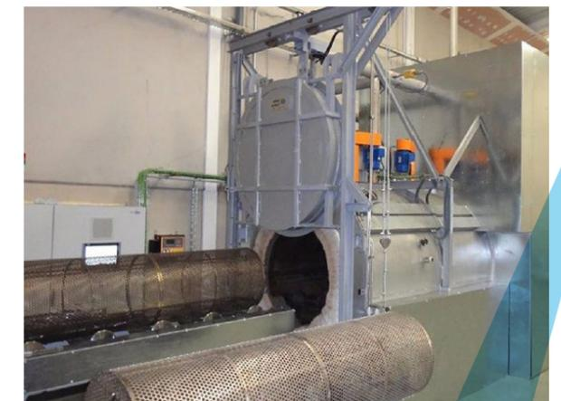
Figura 31. Reactor piloto de pirólisis para palas de aerogenerador.
