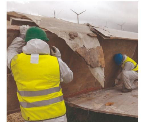
Figura 27. Operario cortando un fragmento de pala de aerogenerador. Se aprecian restos de las láminas de madera de balsa unidas al material compuesto. Fuente: LIFE Refibre (2021)<sup>105</sup>.
