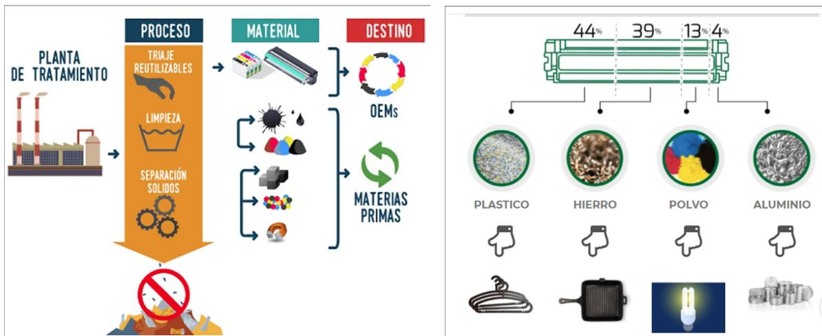
Figura 15. Proceso de tratamiento de cartuchos de tinta y tóner recogidos (izq.) y ejemplo de materias primas resultantes del proceso de reciclaje de un tóner (der.).
