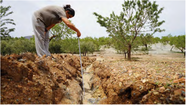
Medición de la erosión provocada en el suelo de un almendral tras un episodio de lluvia torrencial
