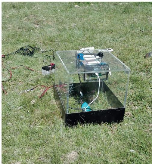
Cámara de incubación portátil para medidas puntuales de intercambio de CO<sub>2</sub> en suelos.
