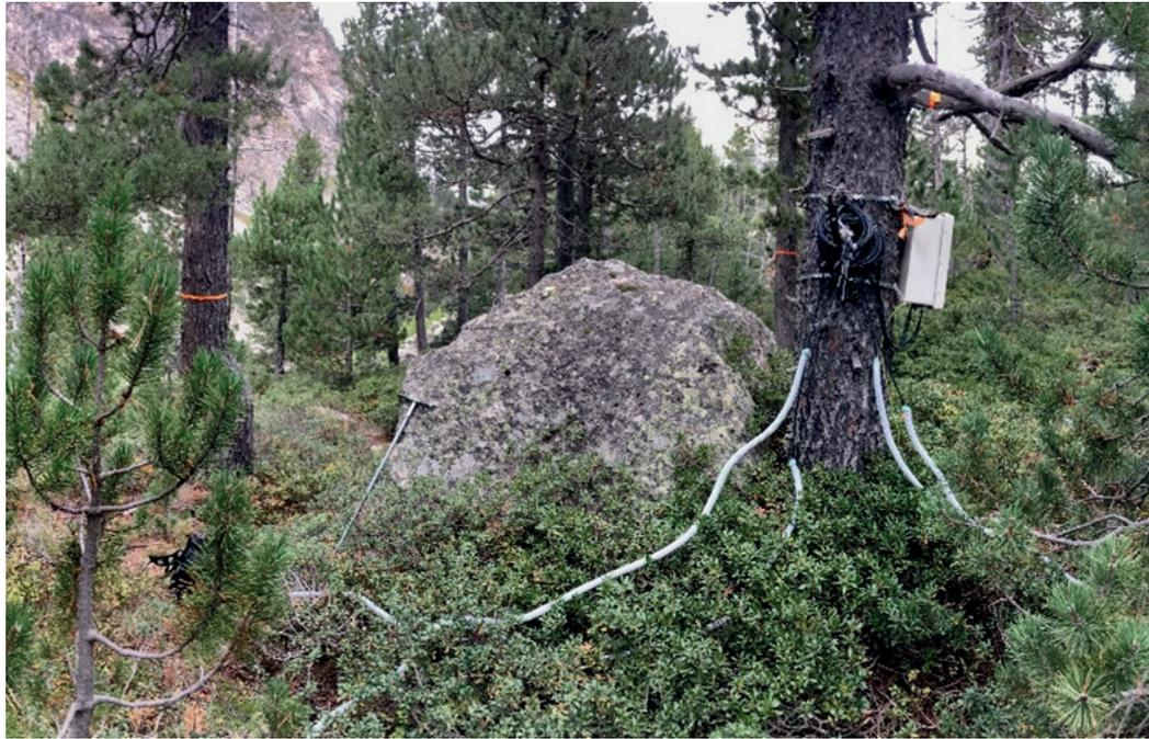
**Figura 1.** Instalación de sensores de humedad del suelo usados para la validación del modelo de balance hídrico en una de las parcelas de seguimiento del sector Espot del Parque Nacional de Aigüestortes y Estany de Sant Maurici.
