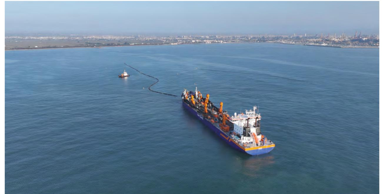
La draga de succión HAM 318, la tercera más grande del mundo por volumen de cántara y primera por eslora y la tubería flotante que la conecta con la playa y aporta el material captado en el yacimiento Cullera-Sueca
