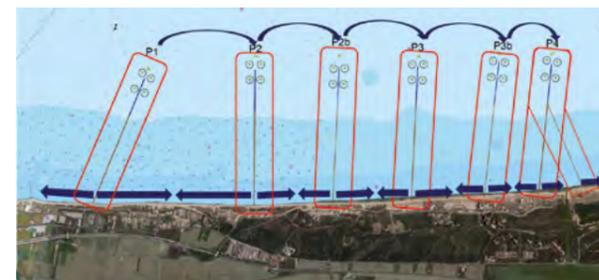
Figura 9. Posiciones de tubería sumergida y proceso de llenado de la regeneración
