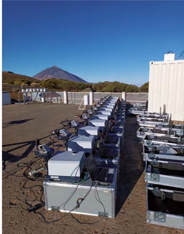
Instrumentación de la red COCCON-España para la medida de GEIs en el Observatorio Atmosférico de Izaña (Tenerife)
