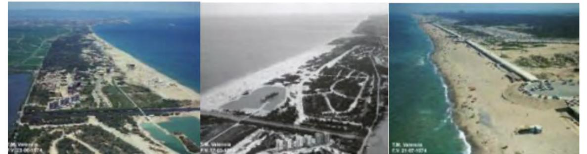
Figura 7. Fotografías aéreas de 1974. Destrucción del frente dunar: en tramo de actuación (izda.), al sur de la actuación en playa Devesa (centro) y por construcción de paseo marítimo en playa del Saler (dcha.)
