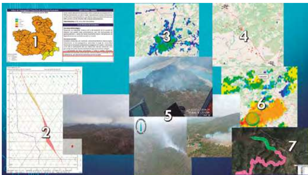
Figura 3: 1: Mapa diario de riesgo con advertencia de posibilidad de tormentas; 2: Radiosondeo para visualización de índices relacionados con posibilidad de tormentas; 3: Detección de la formación de tormentas y posibles trayectorias. 4: Posiciones de impactos de rayos registrados. 5: Comportamiento de los incendios iniciados por rayo en el episodio. 6. Situación de las células con respecto a los incendios activos. 6. Establecimiento de líneas de control apoyadas en áreas de contención de la Red de Áreas de Defensa de la provincia de Albacete. Fuentes INFOCAM y Visor ALCIF (Apoyo a la Lucha de Incendios Forestales) de AEMET
