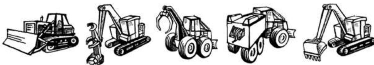
Figura 1 Equipos Pesados (EP) más comúnmente utilizados: bulldócer, taladoras, skidder, equipos de transporte de agua montados sobre autocargadores o skidder, excavadoras.
