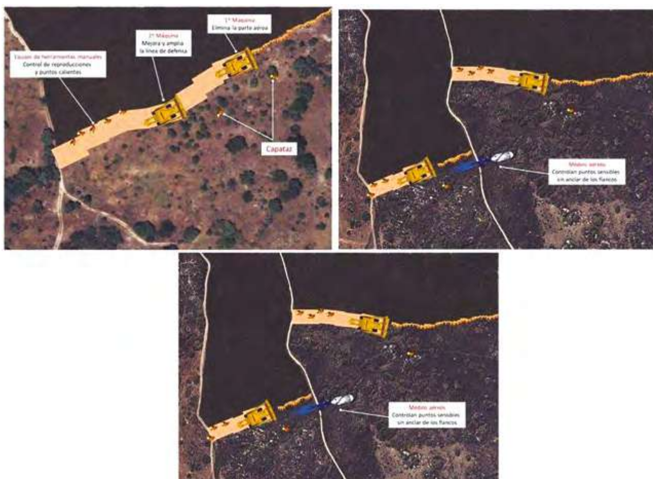
Figura 2. Tipos de avance en ataque directo, continuo (a), alterno (b) y opuesto (c).
