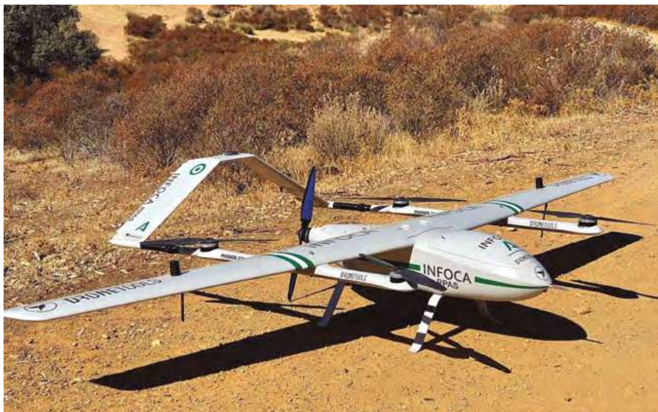
Figura 6. Modelo UAV VTOL AZOR A22 de DroneTools para INFOCA.
