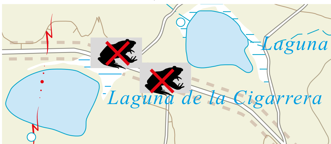
Figura 18. Ejemplo de configuración espacial en la que la vía interrumpe el flujo de movimiento de animales y en la que, cabe esperar una alta concentración espacial de atropellos en el tramo, relativamente pequeño, que comunica ambas lagunas. Cartografía: iberpix (IGN).
