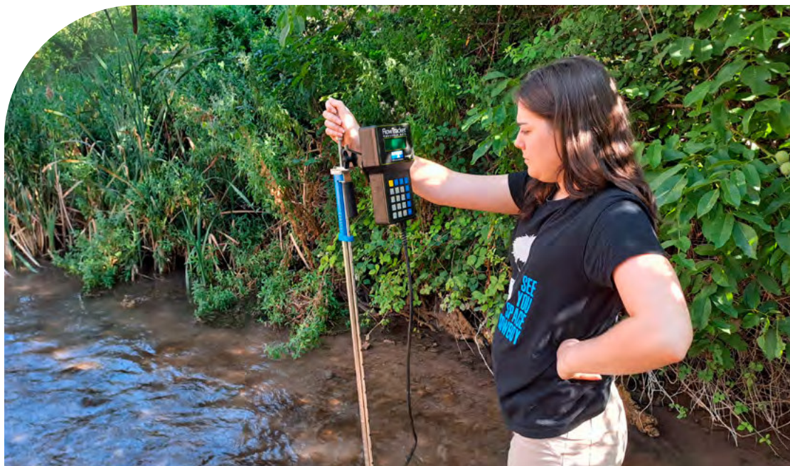
Medición de caudal con tecnología Doppler
