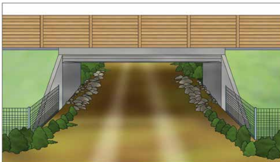
Figura 7.1. Esquema general de un paso inferior multifuncional. Fuente: AT-Minuartia.
