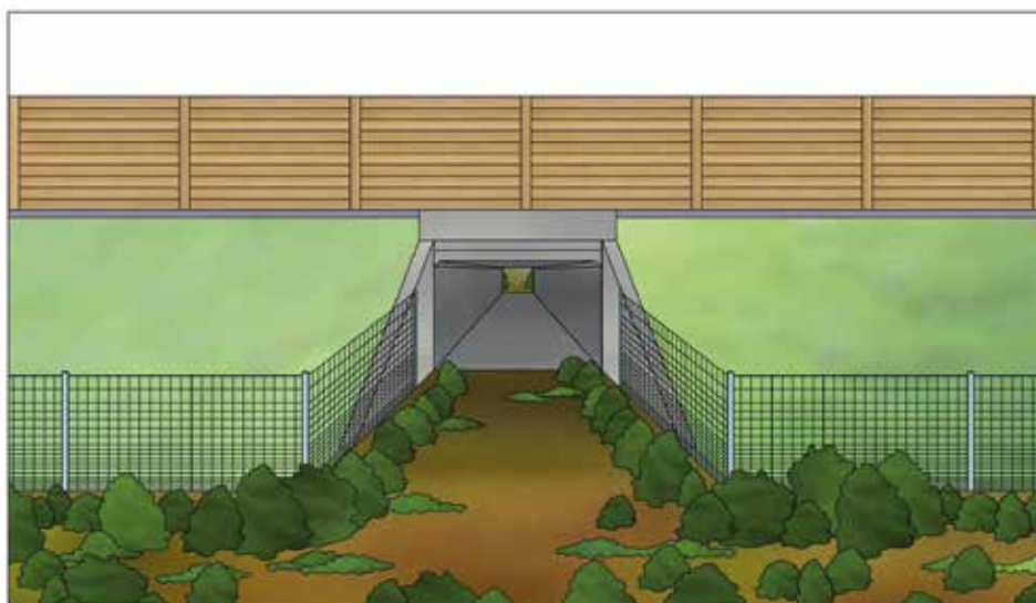
Figura 8.1. Esquema general de un paso inferior específico para pequeños vertebrados. Fuente: AT-Minuarta.
