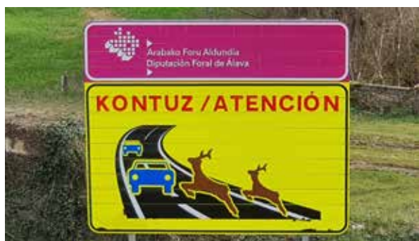
Figura 18.2. Mensaje de advertencia destacado mediante paneles con fondo amarillo retrorreflectante. Foto: Minuartia.
