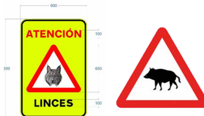
Figura 18.7. Señal que incluye la silueta del jabalí (P-24a), a la derecha, normalizada por la Dirección General de Tráfico, que refleja la importancia de la especie en los accidentes con fauna salvaje, y señal normalizada en Castilla-La Mancha para advertir de zonas de cruce de lince, a la izquierda, con fondo fluorescente para mayor visibilidad por la noche. Fotos: Junta de Comunidades de Castilla-La Mancha y Dirección General de Tráfico.
