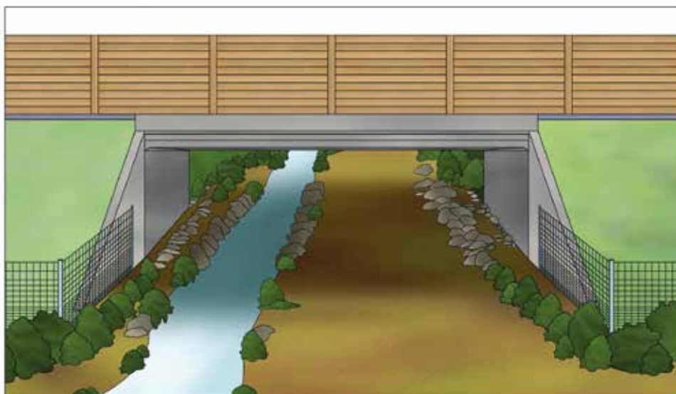
Figura 7.6. Disposición de una acequia en uno de los márgenes de un paso inferior multifuncional dejando, amplias franjas destinadas al paso de fauna. Fuente: AT-Minuarta.
