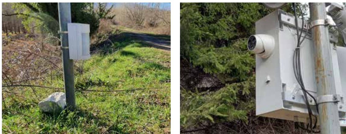
Figura 19.3 Sensor de movimiento de infrarrojo pasivo y cámara térmica instalados en las inmediaciones de las vías para detectar la aproximación de los animales y activar las señales de advertencia a las personas conductoras. Fotos: Minuartia.
