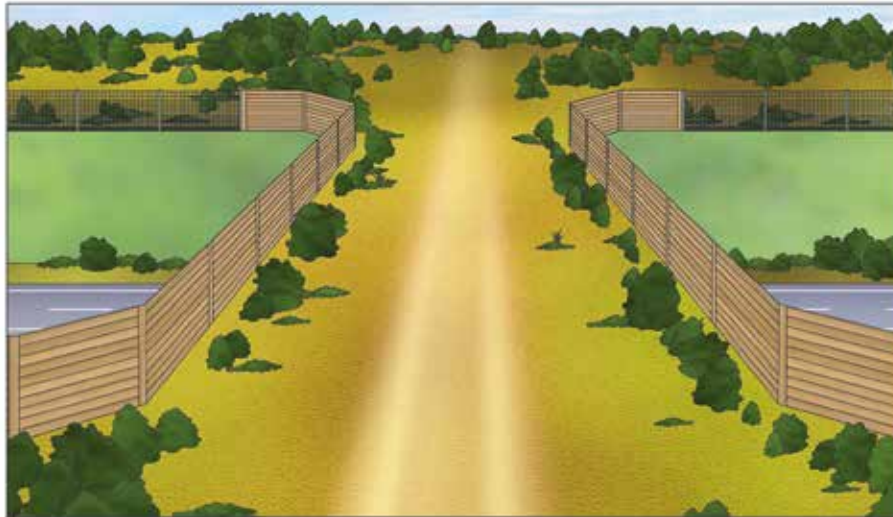
Figura 3.1. Esquema general de un paso superior multifuncional. Fuente: AT-Minuarta.
