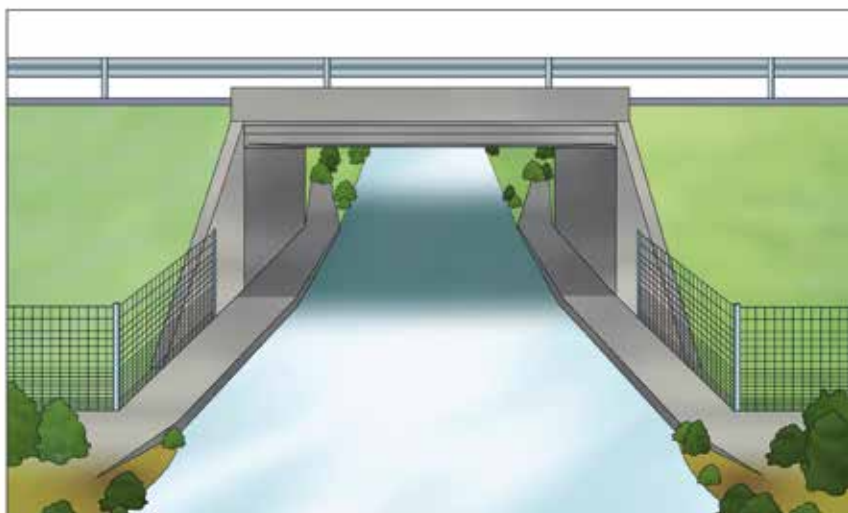
Figura 9.1. Esquema general de un drenaje adaptado para animales terrestres. Fuente: AT-Minuartia.
