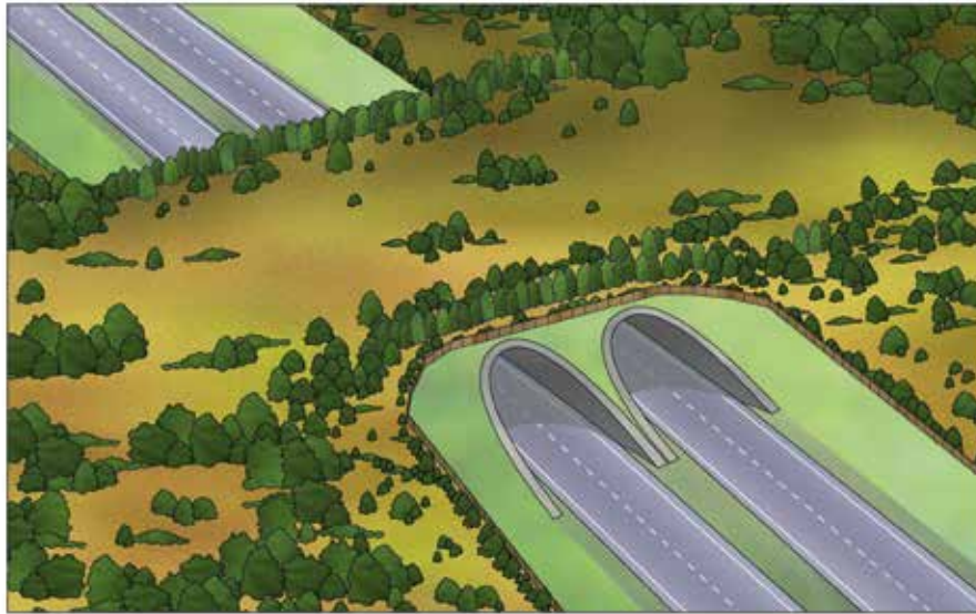
Figura 1.1. Esquema general de un ecoducto. Fuente: AT-Minuartia.
