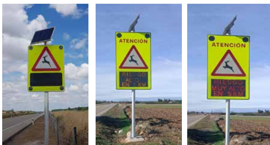
Figura 18.4. Señales reforzadas con mensaje variable que advierte de riesgo alto (centro) y muy alto (derecha) en un tramo de 5 km. Si el nivel de riesgo no alcanza el umbral establecido no se muestra ningún mensaje (izquierda). Fotos: Consejería de Movilidad y Transformación Digital de la Junta de Castilla y León.
