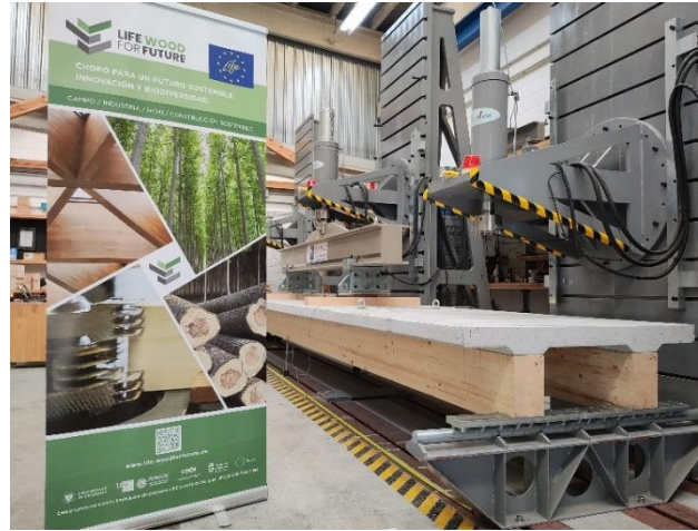
Ensayo de prototipo mixto madera hormigón MCLamBS.
