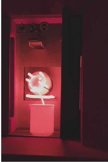
Figura 15. Preparación, mediante fusión-disolución, de una muestra para análisis de tierras raras.
