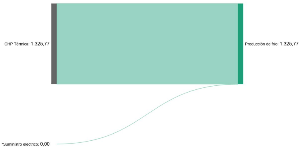
Figura 20. Distribución del consumo según fuentes de energía de la producción de frío (GWh) en 2021. *Nota: Suministro eléctrico tiene un valor real de 1,14 MWh, fuera de escala del grafico representado.
