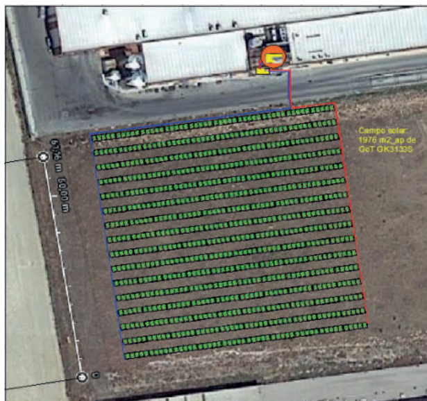
Configuración de la instalación solar
