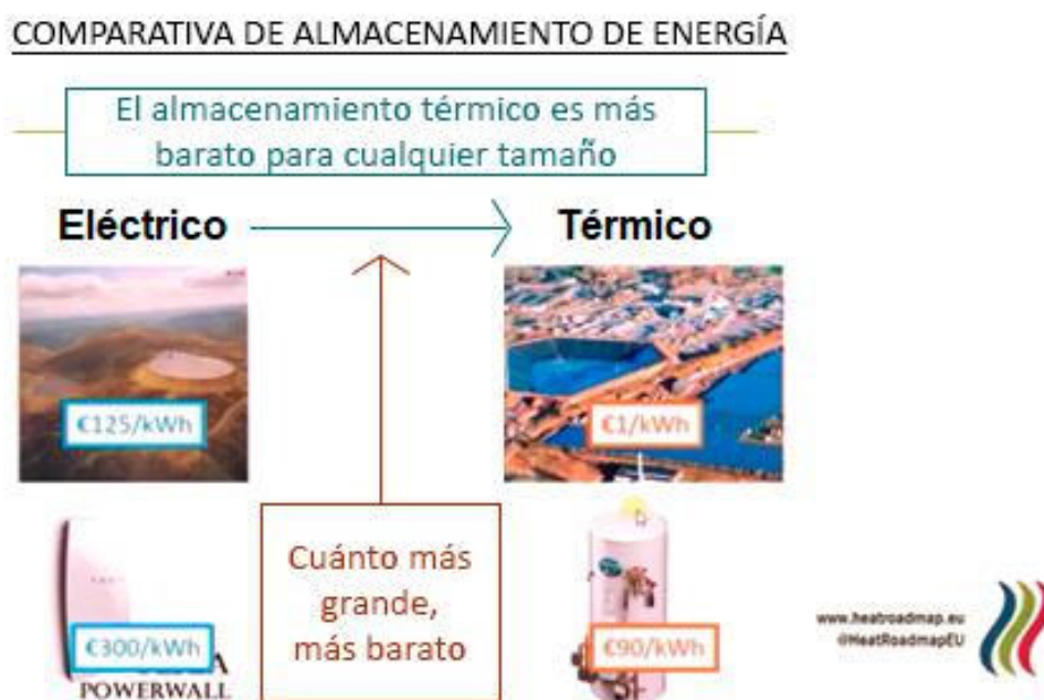
Figura 13: Comparativa entre los costes unitarios de inversión entre la acumulación eléctrica y la acumulación en forma de calor
