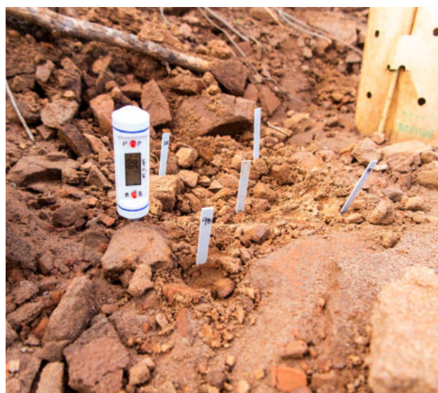
Figura 7. Termómetro para medir la temperatura del suelo y cebos insertados para evaluar la actividad alimentaria de los invertebrados edáficos.
