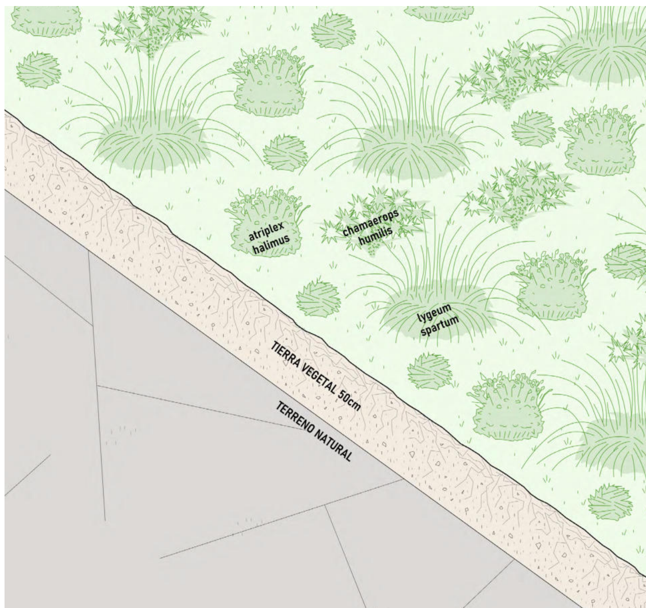
Figura 2. Imagen del aporte y extendido de capa de tierra vegetal.
