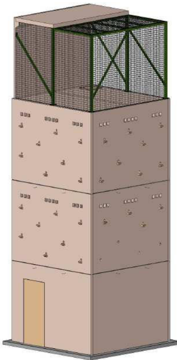
Figura 1: Vista general del primillar con jaula integrada
