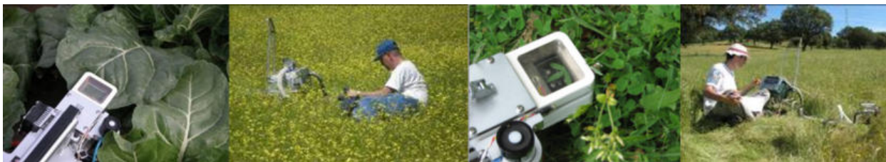
Análisis del intercambio de gases entre la atmósfera y la planta empleando un sistema portátil de medida de CO 2 y vapor de agua mediante analizadores de infrarrojos. Fuente: CIEMAT.
