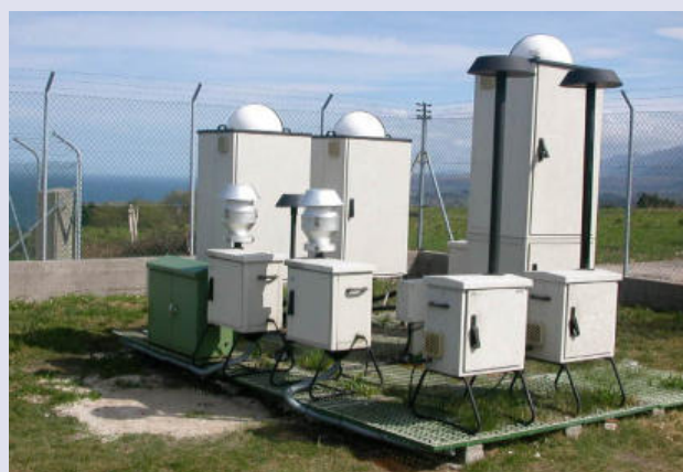
Figura 10. Estaciones de la red EMEP/VAG/CAMP en España: EMEP (azul), VAG (amarillo), EMEP-CAMP (rojo). Derecha: estación de vigilancia de la calidad del aire de la red EMEP/VAG/CAMP de Niembro (Asturias), área de captadores de partículas. Fuente: MITECO
