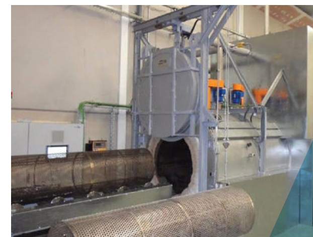
Figura 31. Reactor piloto de pirólisis para palas de aerogenerador. Fuente: Reciclalia.
