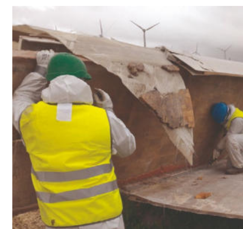
Figura 27. Operario cortando un fragmento de pala de aerogenerador. Se aprecian restos de las láminas de madera de balsa unidas al material compuesto. Fuente: LIFE Refibre (2021) 105 .
