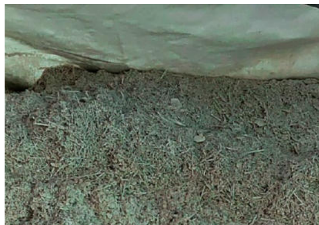
Figura 28. Fibra de vidrio resultante. Fuente: LIFE Refibre (2021) 105 .
