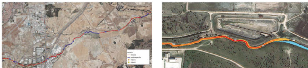
Figura A.4.10.4 (a) Modelo de erosión (en rojo) y sedimentación (en azul) para el tramo comprendido entre las EDARs y (b) detalle de los procesos erosivos en un tramo con intensidad moderada (naranja) y severa (rojo).
