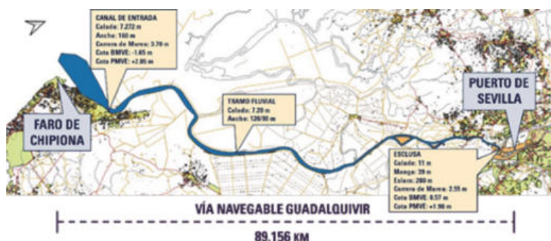
Figura A.2.1.2 (a) Croquis y características de la Vía Navegable del Puerto de Sevilla y (b) navegación en la Eurovía E-60.02.
