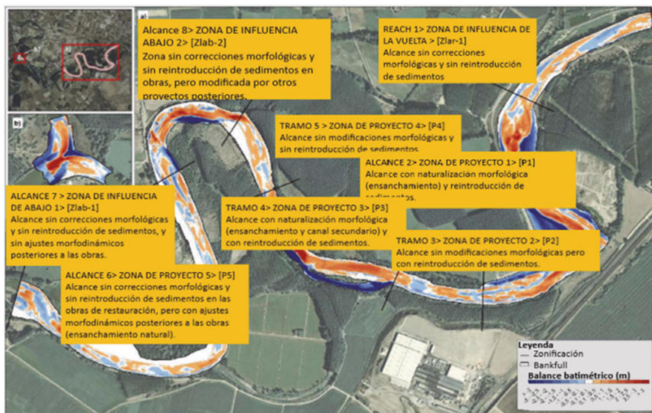
Figura. A.2.2.3. Balance batimétrico interanual (2014-2019) en la zona del proyecto, que muestra las zonas que han descendido durante ese periodo (colores fríos), en su mayoría como resultado de la excavación/reconexión, pero también debido a la reorganización geomórfica posterior a las obras; y las zonas que se han elevado (en colores cálidos), revirtiendo la incisión previamente en curso. Fuente: Gobierno de Navarra & MN Consultores.
