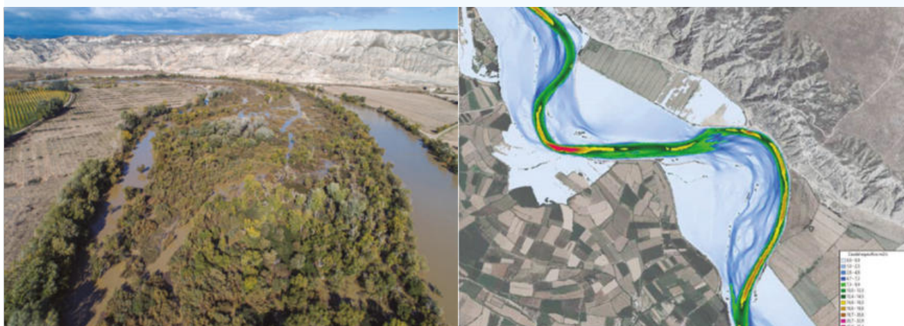
Figura A.2.3.4. Mejana del Tambor. (a) Ramales de libre circulación en funcionamiento y (b) simulación de caudal específico, caudal (m 3 /s) por unidad de ancho (m 2 ). Fuente: CHE
