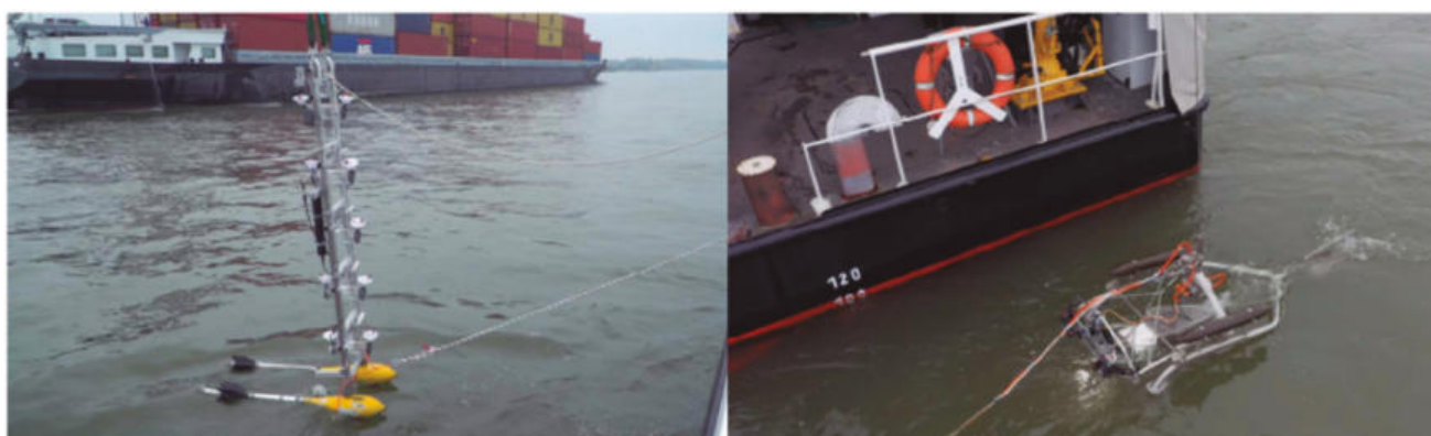
Figura 2.5. Seguimiento de la carga en suspensión y de la carga de fondo en el Bajo Rin. Fuente, derechos de autor: BAW, Karlsruhe (Instituto Federal de Ingeniería e Investigación de Vías Navegables)
