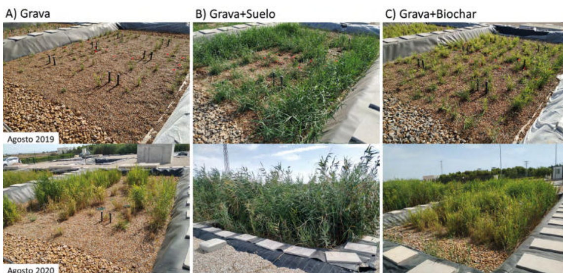
Figura 6. Evolución del crecimiento de los ejemplares de Phragmites australis en un año (agosto 2019 – agosto 2020) en los diferentes sustratos: A) grava; B) grava+suelo y C) grava+biochar.
