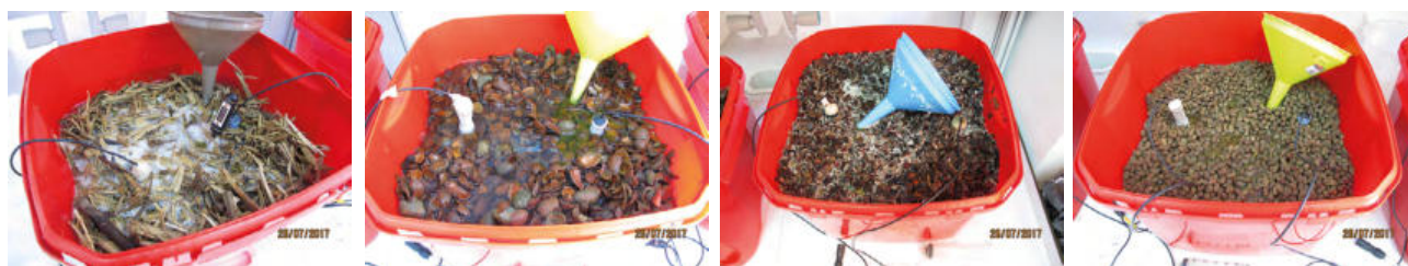
Figura 5. Ensayos para seleccionar el sustrato más adecuado a utilizar en los biorreactores desnitrificadores (Díaz-García et al., 2020). De izquierda a derecha astillas de cítrico (a), cáscara de almendra (b), residuos de algarroba (c) y huesos de aceituna (d).
