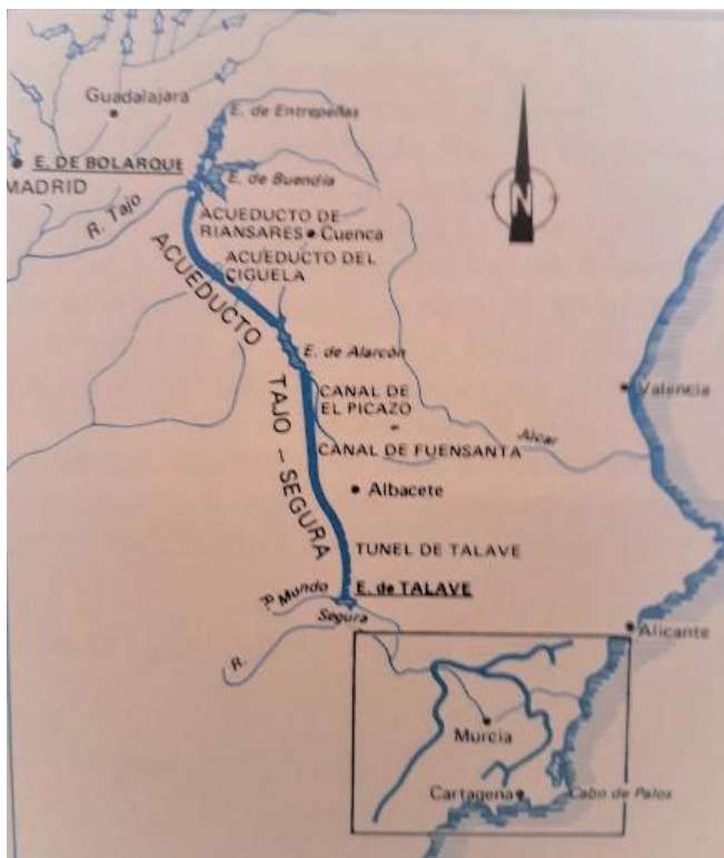
Figura 3.32. Esquema del trazado del ATS. Fuente: Sandoval (1989:51).
