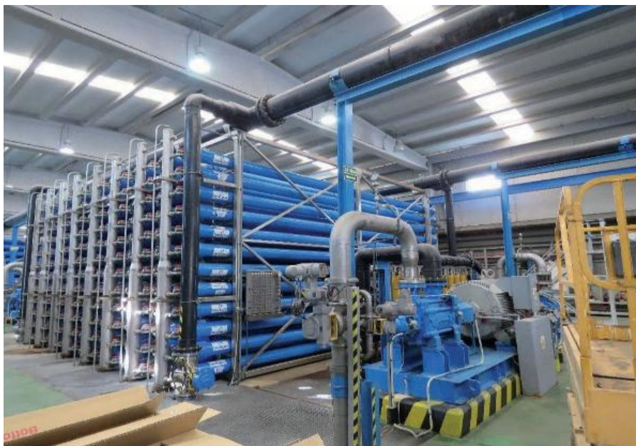
Figura 1.15. Bastidores de ósmosis inversa en la desaladora de Escombreras. Foto: M. B. Bernabé-Crespo.
