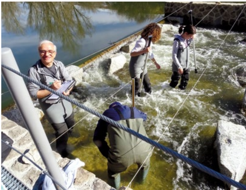
FIGURA 40 Campana de monitoreo para la estimación de calados y velocidades
