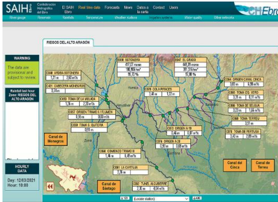
Figura 87. Imagen de SAIH-Ebro mostrando datos del caudal circulante por diversos canales pertenecientes al sistema de Riegos del Alto Aragón.
