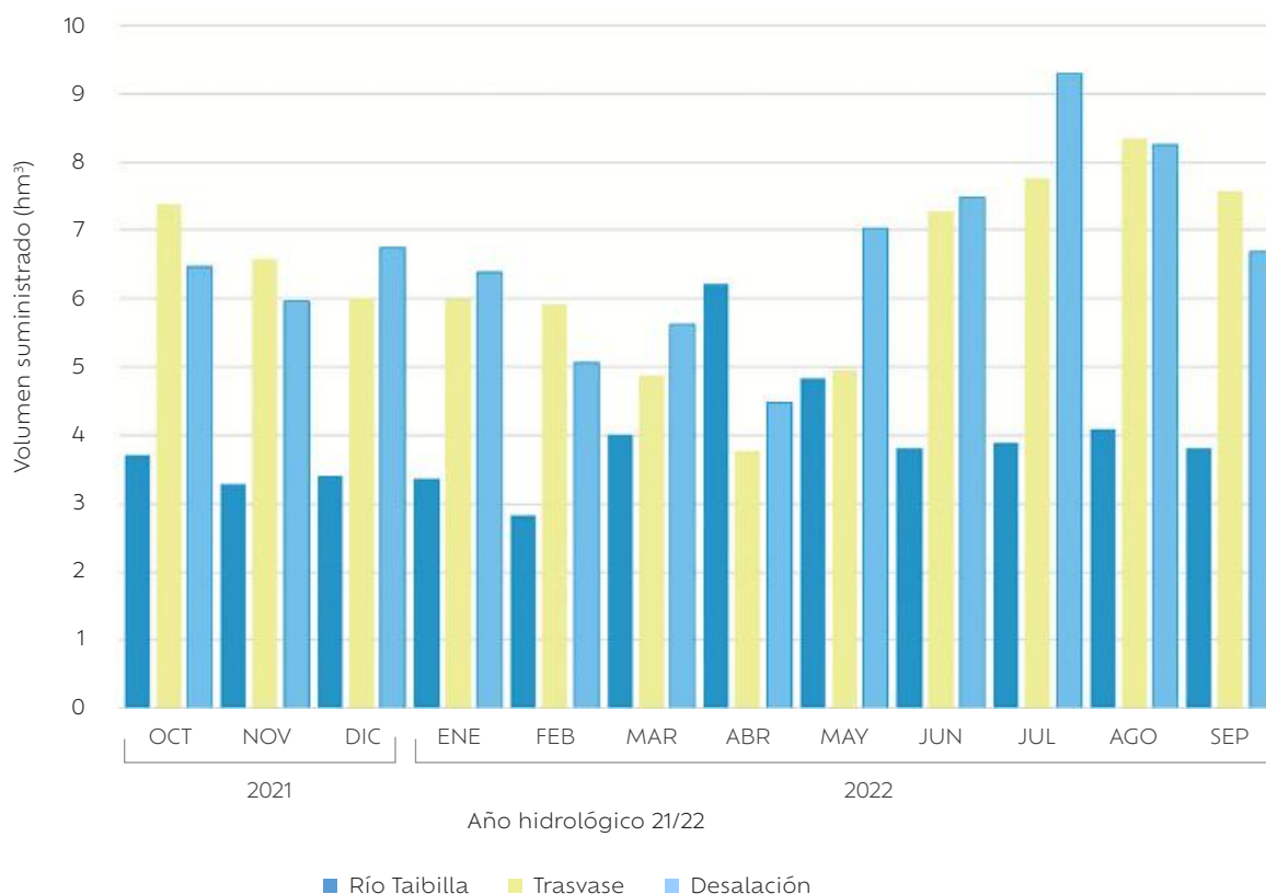
Figura 131. Volumen suministrado en la Mancomunidad de Canales del Río Taibilla, año hidrológico 21/22.
