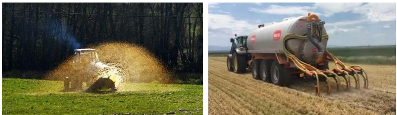
**Figura 9.31.** Izquierda: Aplicación de purines mediante sistema en abanico (Foto: [Roi Fernández, La Voz de Galicia](#)). Derecha: Aplicación de purines mediante sistema de inyectores (Imagen cedida por [Rigual](#)).
