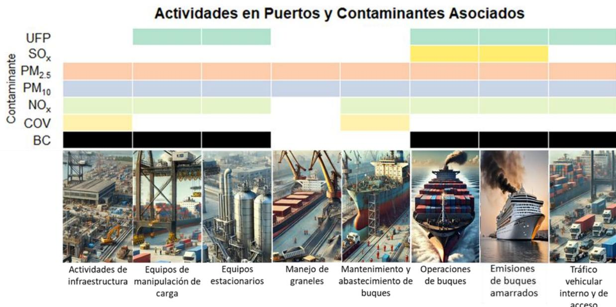
**Figura 9.45.** La Figura ilustra las principales actividades contaminantes en los puertos y los contaminantes atmosféricos asociados a cada una de ellas. (Imágenes creadas mediante IA, software DALL-E™ y Canvas Multimedia Mágico™).
